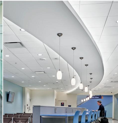
Panneaux Optima<sup>®</sup>, système de suspension Prelude<sup>®</sup> XL<sup>®</sup>, garniture Axiom classique
