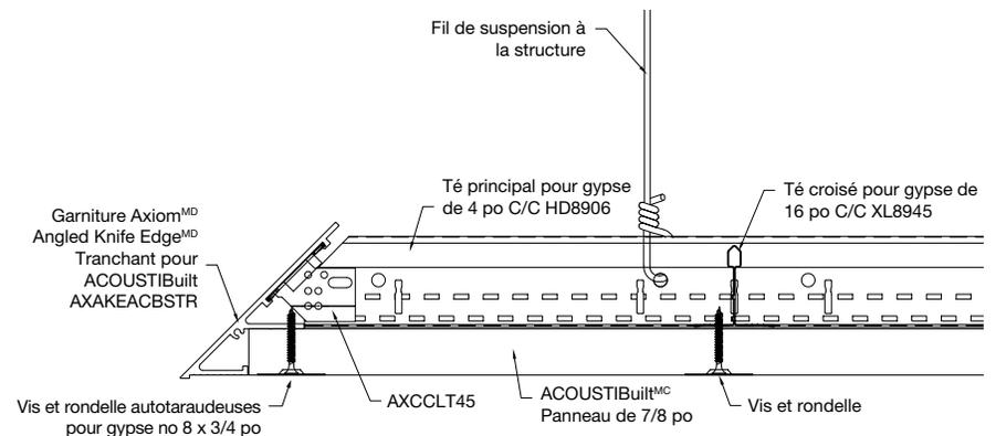
Garniture AXIOM à tranchant effilé Knife Edge pour les applications ACOUSTIBuilt
