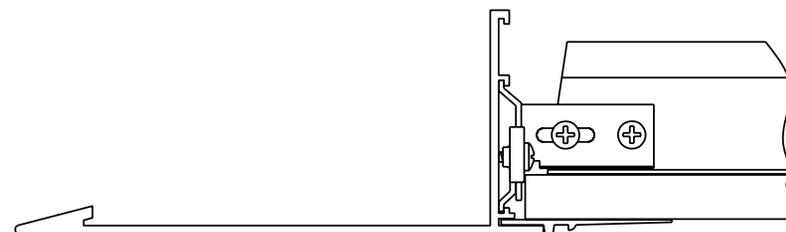
AXDWT dans AXKE2STR – Garniture Axiom<sup>MD</sup> Knife Edge<sup>MD</sup> Tranchant avec garniture inférieure pour gypse
