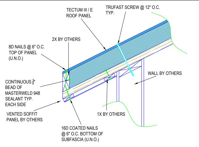
NOTE: OVERHANG DETAIL FOR TECTUM COMPOSITE PANELS. MAXIMUM OVERHANG FOR 5" OR THICKER PANELS IS 24". THE OVERHANG IS ALSO LIMITED TO 1/3 OF THE PANEL LENGTH OR WIDTH EXTENDING OVER THE WALL TO THE INSIDE. MAXIMUM OVERHANG ALONG PANEL WIDTH IS 16" WHEN A FULL WIDTH PANEL IS AT THE EDGE.
