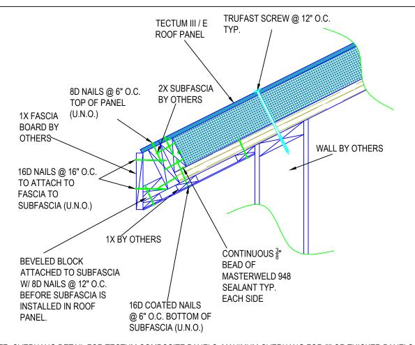
NOTE: OVERHANG DETAIL FOR TECTUM COMPOSITE PANELS. MAXIMUM OVERHANG FOR 5" OR THICKER PANELS IS 24". THE OVERHANG IS ALSO LIMITED TO 1/3 OF THE PANEL LENGTH OR WIDTH EXTENDING OVER THE WALL TO THE INSIDE. MAXIMUM OVERHANG ALONG PANEL WIDTH IS 16" WHEN A FULL WIDTH PANEL IS AT THE EDGE.
