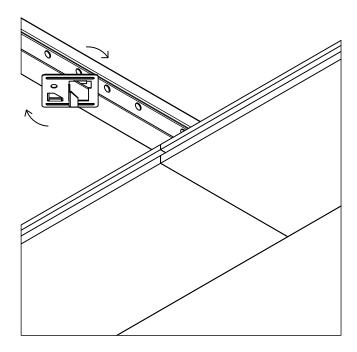
4) ENSURE THAT ALL OF THE CLIPS 24" O.C. ALONG THE LENGTH OF THE PLANK ARE TIGHTLY ENGAGED WITH THE GROOVE OF THE PLANK BEFORE LETTING GO OF THE PLANK.
