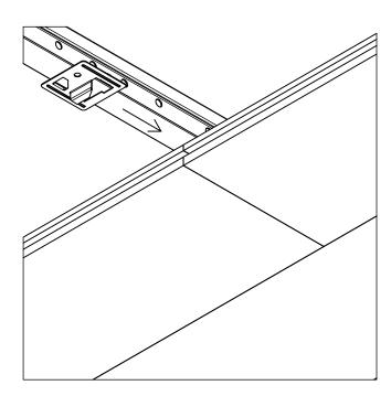
2) WHILE HOLDING THE PLANK TIGHTLY UP AGAINST THE GRID, INSTALL CHANNELED PLANK CLIPS ONTO ALL OF THE MAIN BEAMS SPANNING THE LENGTH OF THE PLANK BY TWISTING THE CLIPS 45° SO THAT THE SMALL FLANGES HOOK AND ENGAGE OVER THE LOWER FLANGE OF THE MAIN BEAMS.
