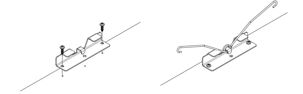
SCREW PANEL BRACKET W/ 2 SCREWS TO PANEL
